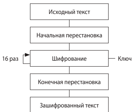
Рис. 73. Обобщенная схема шифрования в алгоритме DES
