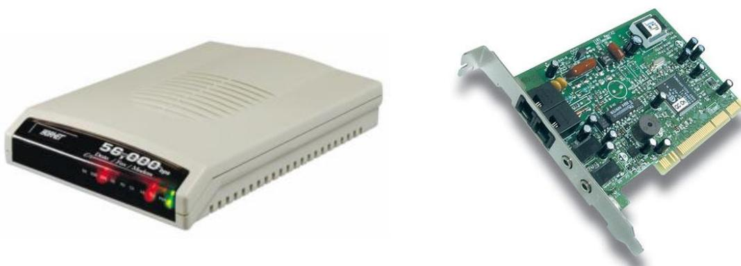
Рис. 63. Модемы во внешнем (слева) и внутреннем (справа) исполнении ошибок.
