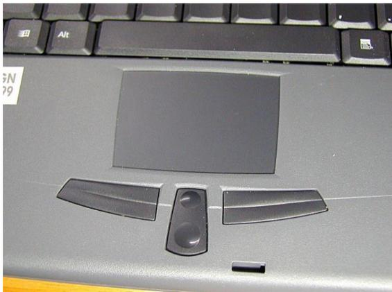
Рис. 47. Тачпад на клавиатуре мобильного компьютера
