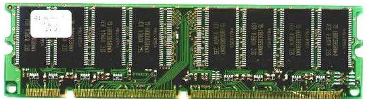
Рис. 34. Модуль памяти DIMM
