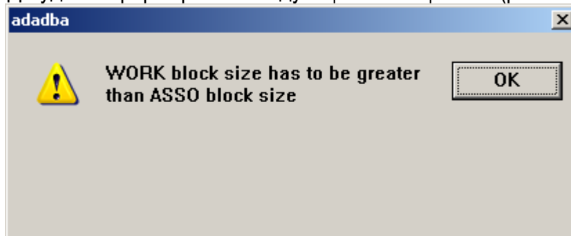
Рис 5.4. Информационное сообщение, получаемое при превышении размера файла ассоциатора над размером рабочего файла
