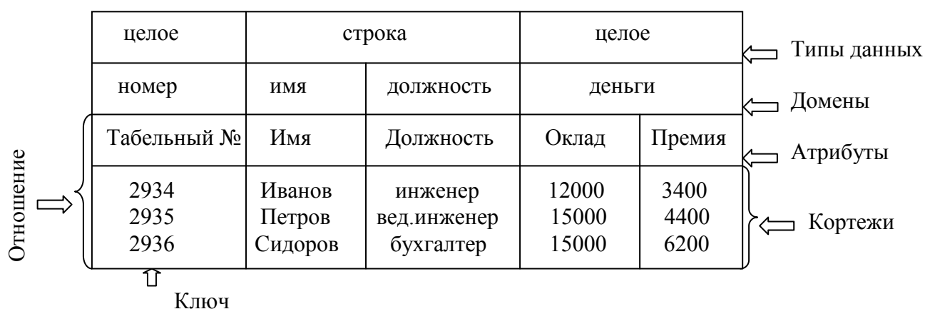
Рис.3.1. Основные компоненты реляционного отношения
