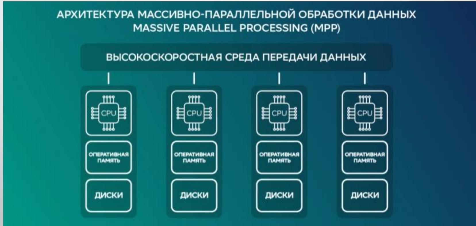
В такой архитектуре система состоит из нескольких независимых узлов, соединенных по сети.
